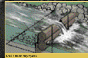
Seuil à troncs superposés
